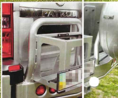
Задний бампер-калитка: с одной стороны запаска, с другой – ящик для канистры.
