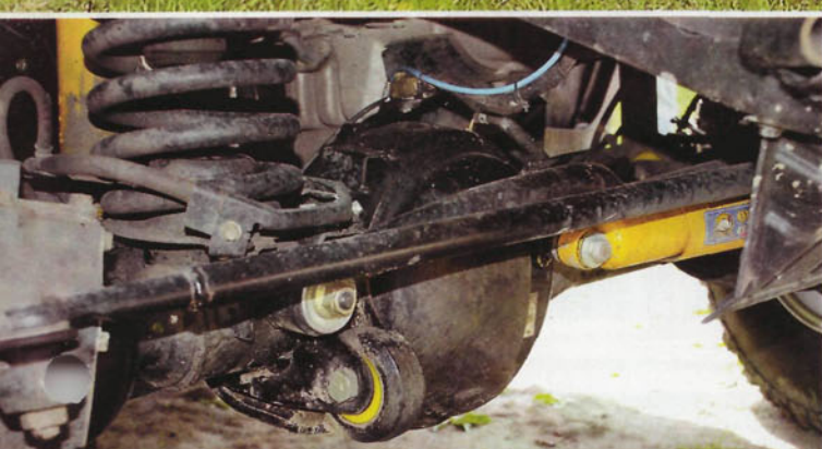
Желтым цветом окрашены элементы подвески австралийской фирмы Old Man Emu – сайлент-блоки, демпфер.
