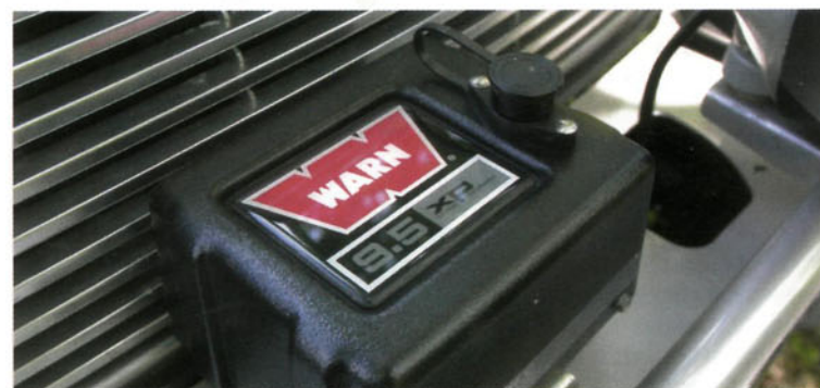
Лебедка фирмы Warn с 30-метровым тросом и мощным электромотором рассчитана на тягу до 4300 кг. Управляется проводным пультом
