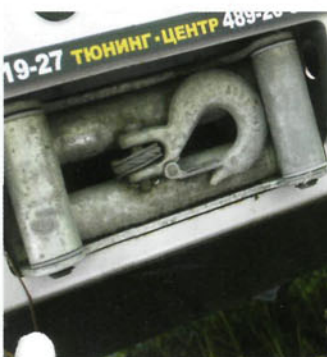
Механическая часть лебедки стационарно интегрирована в передний бампер
