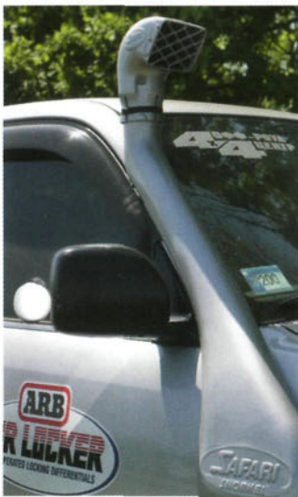
Шноркель с регулируемой направленности забора воздуха
