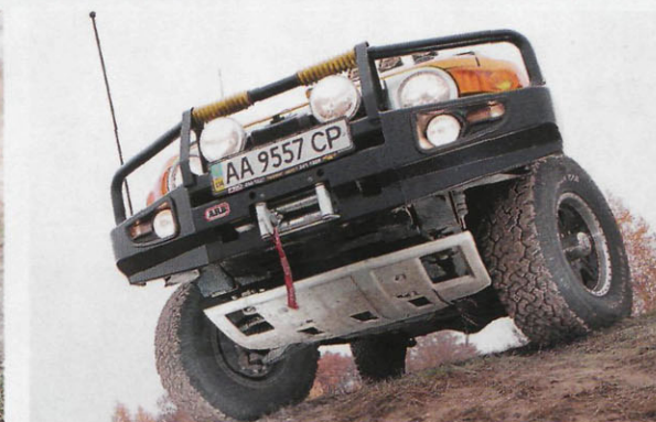
При проезде рыхлого песка и грунта передняя защита выполняет функцию лыжи, на которой машина скользит
