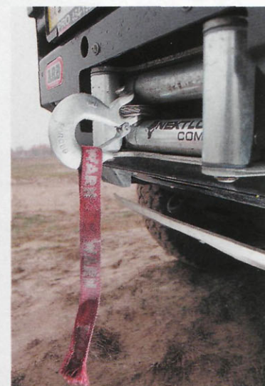
Обрывок фала на крюке лебедки поможет быстро размотать трос
