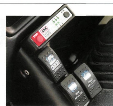
Турботаймер охлаждения турбины, кнопки включения компрессора и блокировок
