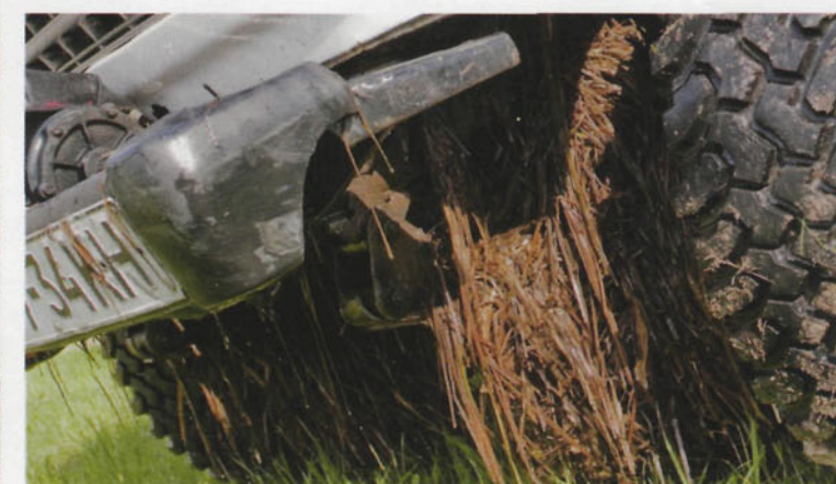
Штатные колеса формата 205 R16 уступили место внедорожным шинам размера 35x12.5 R15, радиус которых больше базовых на 8 см
