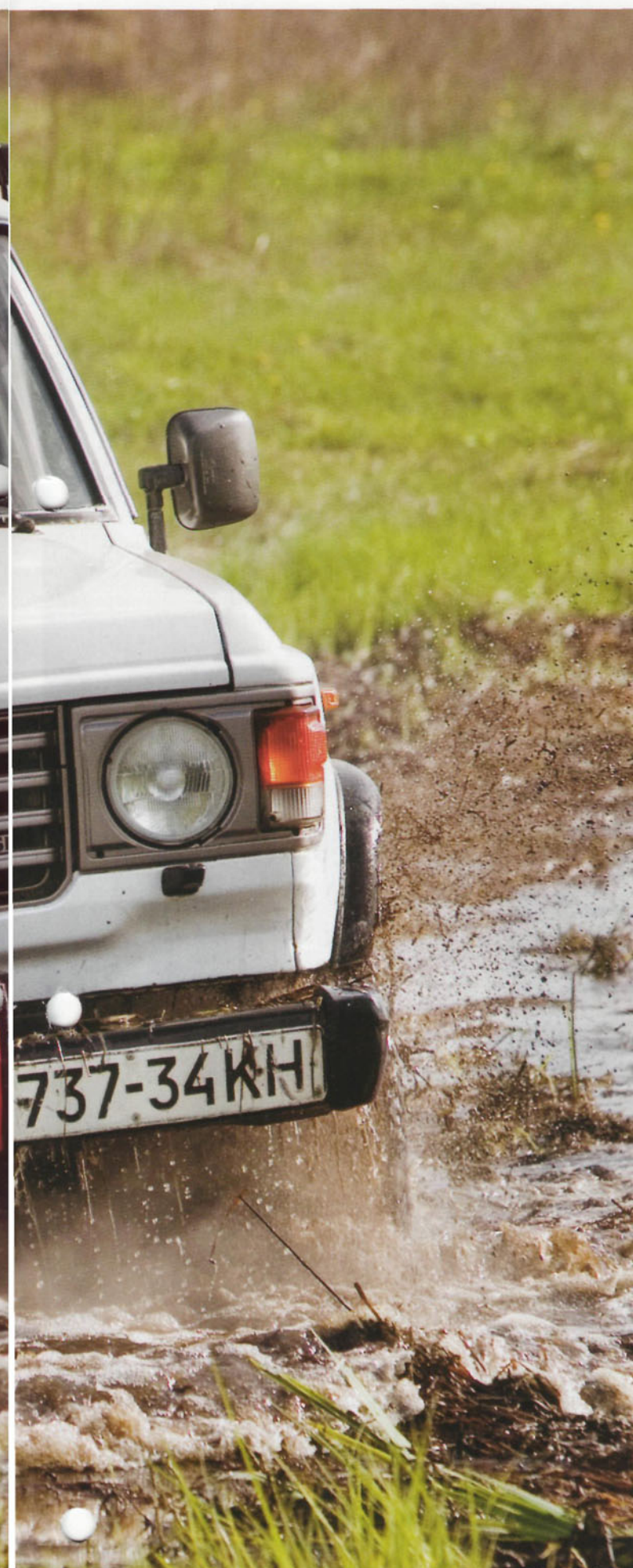
Штатные колеса формата 205 R16 уступили место внедорожным шинам размера 35x12.5 R15, радиус которых больше базовых на 8 см
