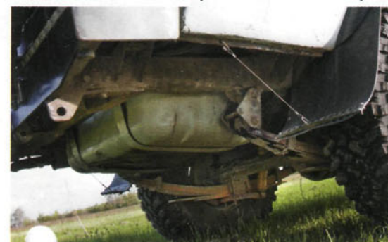
Разместившийся под кормой дополнительный топливный бак от «ЗИЛ-130» обеспечил запас топлива в 200 л
