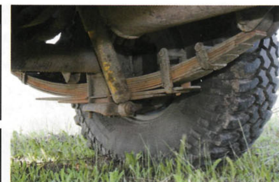
Тюнинг-овые рессоры по долговечности уступают заводским
