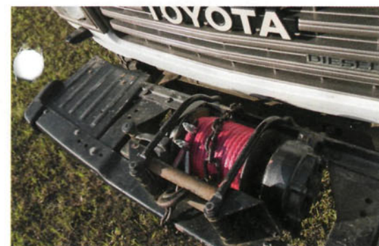
В лебедке металлический трос заменен на полимерный
