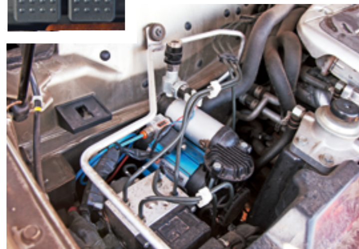
Управление блокировкой дифференциалов производится из салона. Компрессор под капотом
