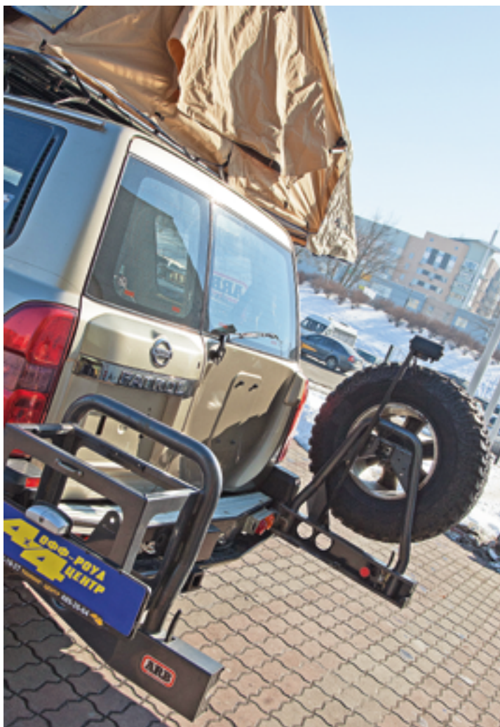
На силовом заднем бампере гармонично расположились носители для полноразмерного запасного колеса и дополнительной канистры с топливом
