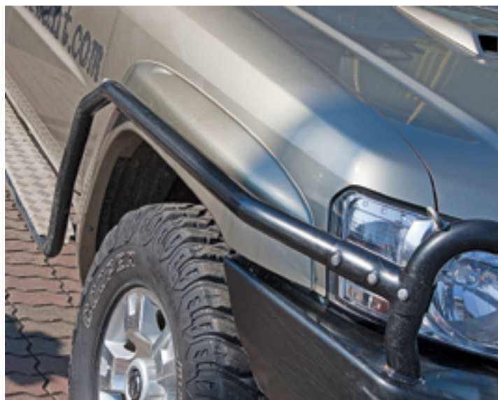
Для надежной защиты кузова сбоку установлен трубчатый каркас, защищающий передние крылья, и комплект порогов-подножек, облегчающих посадку
