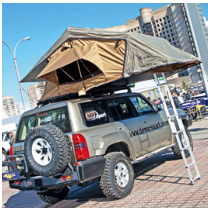
На силовом заднем бампере гармонично расположились носители для полноразмерного запасного колеса и дополнительной канистры с топливом
